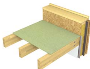
Structure lamellé-collé ou BMR ou bois massif
